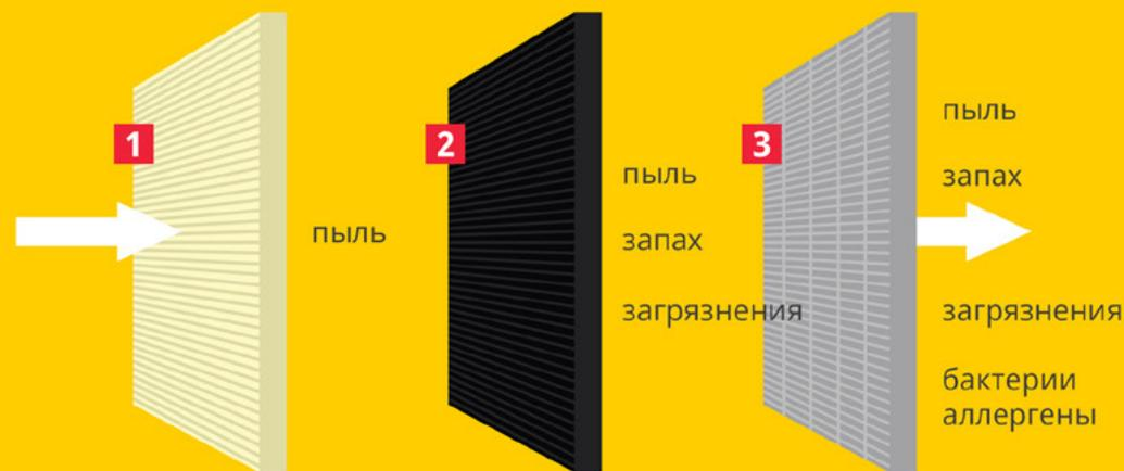
Угольные фильтры салона являются усовершенствованным продолжением противопыльных фильтров. Они имеют многослойную конструкцию, которая состоит из слоев волокна и кокосового угля.
